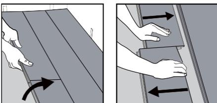
Separe toda la fila levantándola con delicadeza en un ángulo. Para separar las juntas finales de los tablonces, déjelos planos en el suelo y deslícelos para separarlos. Si los tablonces no se separan fácilmente, los puede levantar ligeramente en un ángulo (5°) al deslizarlos.
