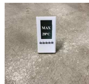
Vloertemperatuur meten bij opstookprotocol
